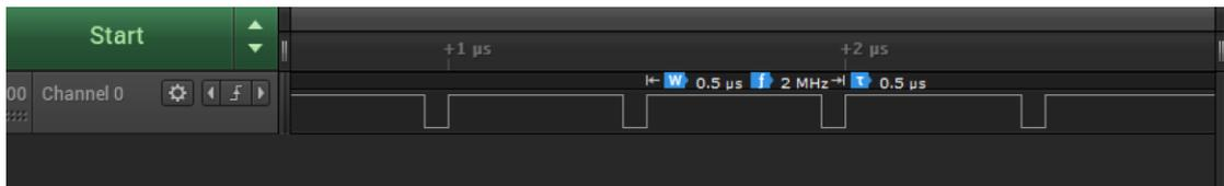
在 tdc\_enable 信号下降后, TDC IP 内部进入重置状态, 重置过程需要一定的时间, 在下一个 tdc\_enable 上升沿前, tdc\_enable 必须保证一段时间的低电平。如果 tdc\_enable 上升时, 内部重置过程还没有完成, 那么 TDC IP 在这个上升沿就不能被正确地启动。
